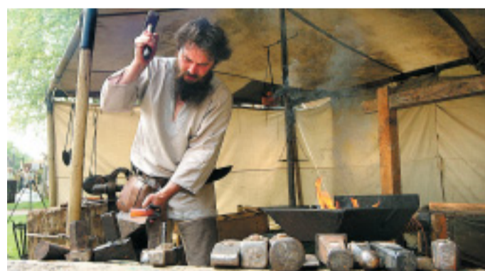
Kräfteige Schläge: Waffenschmied Kay Schadendorf schmiedet ein glühendes Eisen auf dem Amboss zu einem Wurfbeil.
